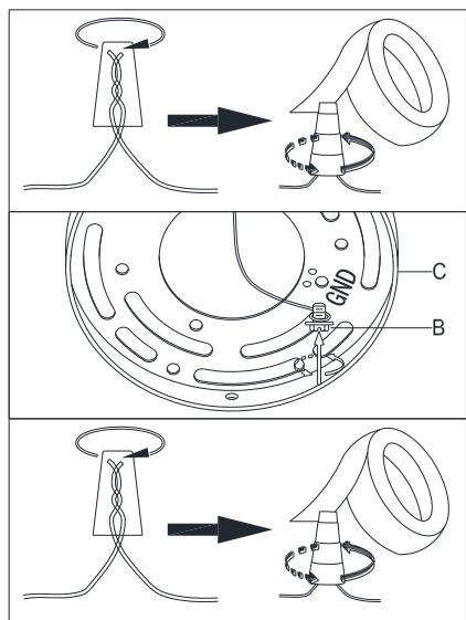
Conectar el CABLE DE CONEXIÓN A TIERRA DE LA LUMINARIA con el CABLE DE CONEXIÓN A TIERRA DE LA CAJA DE CONEXIONES (por lo general el aislamiento verde del cable descubierto) utilizando el conector de tuerca para cables de plástico (A) y envolver la conexión con cinta aislante. Asegurarse de que no quede al descubierto ningún cordón de cable.
