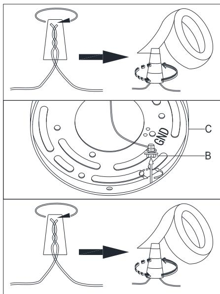
Raccorder le FIL DE TERRE DU LUMINAIRE au FIL DE TERRE DE LA BOÎTE DE JONCTION (normalement l'isolation verte du fil nu) à l'aide du connecteur à coinceur câblé en plastique (A) et envelopper le raccordement avec du ruban isolant. S'assurer qu'aucun fil n'est exposé.
