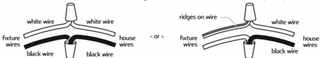
3. Inspeccionar cuidadosamente los cables de la luminaria. El CABLE NEUTRO DE LA LUMINARIA es blanco. El CABLE CALIENTE DE LA LUMINARIA es negro y el CABLE DE CONEXIÓN A TIERRA es de cobre descubierto. Ante la presencia de cualquier duda que impida identificar con seguridad los cables del suministro eléctrico, se recomienda interrumpir la instalación y consultar con un electricista.
