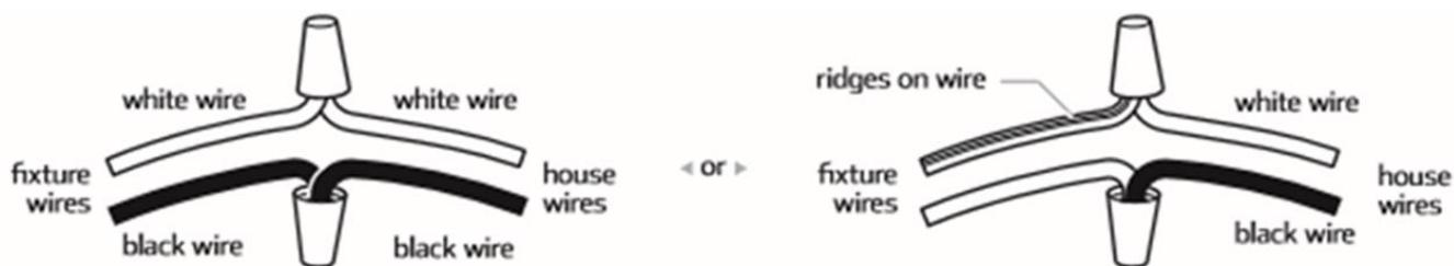
3. Inspecter soigneusement les fils du luminaire. LE FIL NEUTRE DU LUMINAIRE est blanc. Le FIL CHARGÉ DU LUMINAIRE est noir et le FIL DE TERRE est le fil en cuivre nu. En cas de doute et s'il est impossible de déterminer les fils électriques avec confiance, nous recommandons de demander un électricien et de ne pas poursuivre l'installation.
