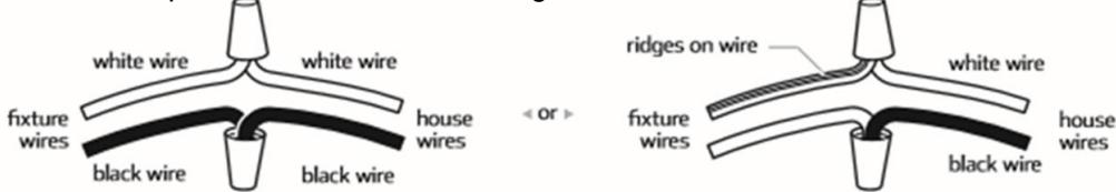
3. Inspeccione cuidadosamente los cables de los accesorios. El ALAMBRE DE FIJACIÓN NEUTRO es Blanco. El CABLE DE ACCESORIOS CALIENTE es negro. Si tiene alguna duda y no puede identificar los cables de alimentación con confianza, le recomendamos que consulte a un electricista y que no continúe con la instalación..
