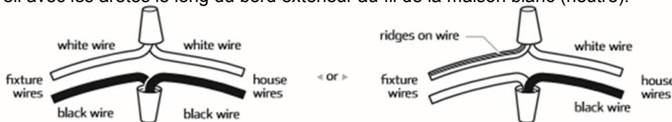
3. Inspectez soigneusement les fils des appareils. Le FIL DE FIXATION NEUTRE est blanc. Le fil HOT FIXTURE WIRE est noir. Si vous avez le moindre doute et ne pouvez pas identifier les fils d'alimentation avec confiance, nous vous recommandons de demander à un électricien et de ne pas poursuivre l'installation..
