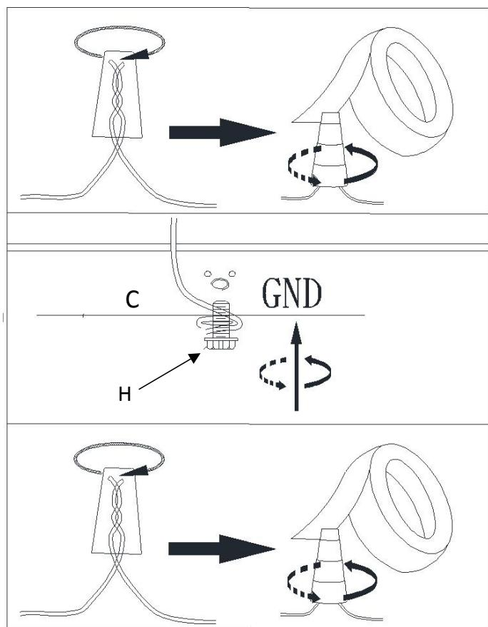
Connectez le FIL DE FIXATION DE MISE À LA TERRE au FIL J-BOX DE MISE À LA TERRE (généralement isolant vert du fil nu) à l'aide du connecteur d'écrou de fil en plastique (D) et enroulez la connexion avec du ruban isolant. Assurez-vous qu'aucun brin de fil n'est exposé.
