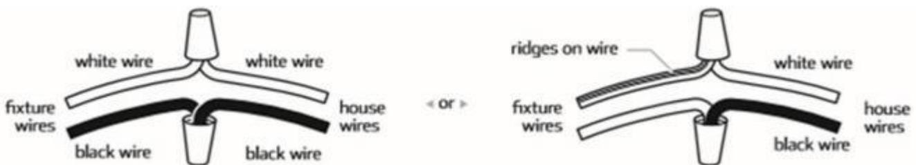
3. Inspeccionar cuidadosamente los cables del artefacto. El CABLE NEUTRO DEL ARTEFACTO tiene BORDES LONGITUDINALES LISOS a su largo. El CABLE CALIENTE DEL ARTEFACTO es SUAVE y el ALAMBRE DE COBRE es el CABLE DE CONEXIÓN A TIERRA. Ante la presencia de cualquier duda que impida identificar con seguridad los cables del suministro eléctrico, se recomienda interrumpir la instalación y consultar con un electricista.
