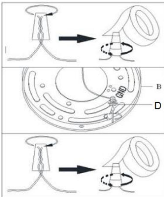
Conecte el CABLE DE TIERRA A TIERRA al CABLE DE TIERRA J-BOX (generalmente aislante verde del cable desnudo) usando el conector de tuerca de plástico para cables (I) y envuelva la conexión con cinta aislante. Asegúrese de que no queden hilos de alambre
