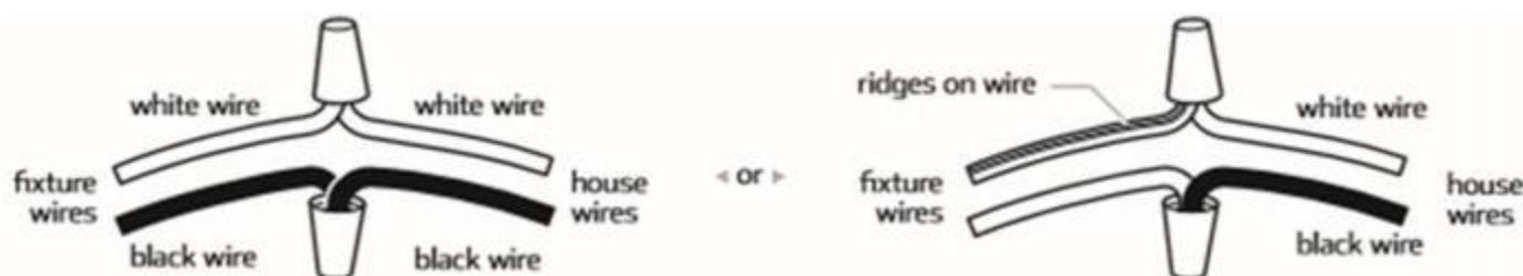
3. Inspecter soigneusement les fils du luminaire. Le CÂBLE NEUTRE DU LUMINAIRE a des RAINURES LONGITUDINALES FINES le long de sa longueur. Le CÂBLE CHAUD DU LUMINAIRE est LISSE et le FIL EN CUIVRE NU est le FIL DE TERRE. En cas de doute et s'il est impossible de déterminer les fils électriques avec confiance, nous recommandons de demander un électricien et de ne pas poursuivre l'installation.
