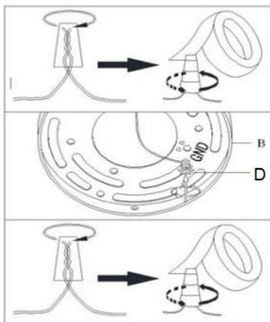
Connectez le FIL DE FIXATION DE MISE À LA TERRE au FIL J-BOX DE MISE À LA TERRE (généralement isolant vert du fil nu) à l'aide du connecteur d'écrou de fil en plastique (I) et enroulez la connexion avec du ruban isolant. Assurez-vous qu'aucun brin de fil n'est
